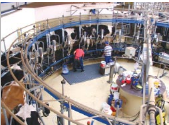
Der Hubboden im Karussell ermöglicht auch kleinen oder großen Melkern eine optimale Arbeitshöhe.
